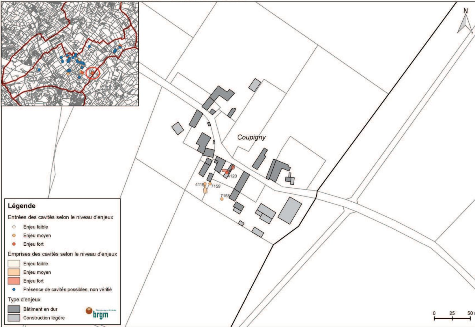
Source : Levés sommaires réalisés par le BRGM à la boussole et au distance-mètre laser (2014). Précision d'ordre métrique à decamétrique. Fond cadastral 2012.
